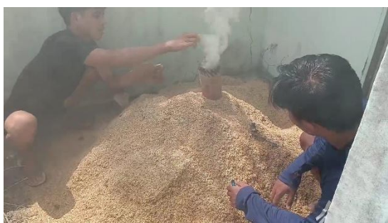
Gambar 1. Proses pembakaran arang sekam
